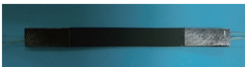
(b) 植入光纤的复合材料拉伸应变测试样品
